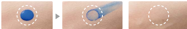
汚れを付けた状態 トイレットペーパーで拭き取ったとき ビデで洗ったとき ※ビデ洗浄の有無にて比較。手に擬似汚れを塗布し、トイレットペーパーで拭き取った場合/20秒ビデ洗浄をした後、軽く水気を取った場合。
